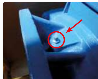
■ Posizione ingrassatore lato comando
